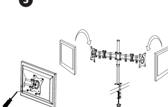
Para completar la instalación, colocar el brazo que sostiene la pantalla en el poste.
