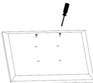
Colocar la base sujetando con los tornillos en la pantalla.
