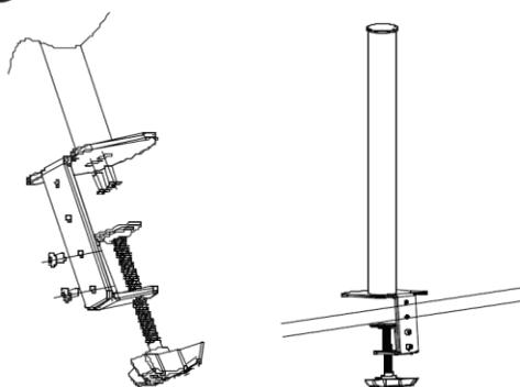
Coloque por la parte inferior del escritorio el ajustador y gire la perilla en sentido horario para fijar. Asegurarse que la abrazadera se ajuste adecuadamente, cuidado de no sobre pasar el ajuste.
